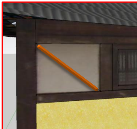
가새 설치 (대각선으로 설치된 막대기)
